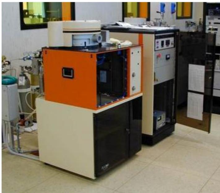
**Fig. 36:** Impianto utilizzato presso l'IFN per gli attacchi con ioni reattivi (RIE).
